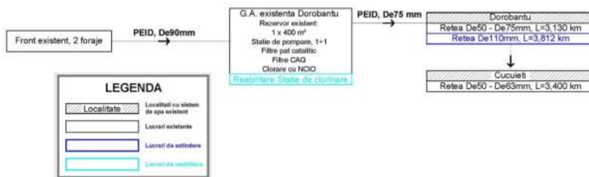
Figură 1.3-15 Schema sistemului local de alimentare cu apa Dorobantu
