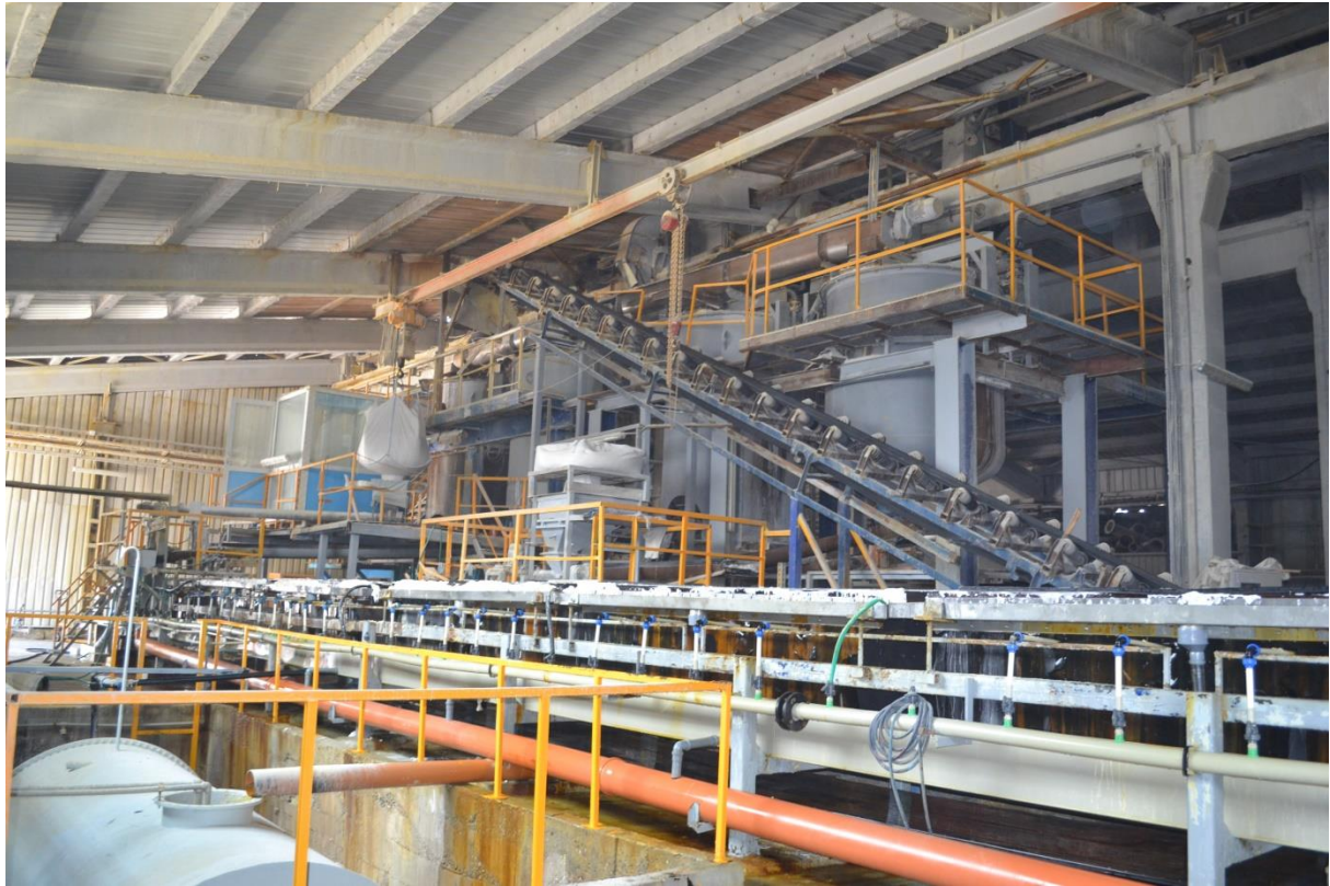
Figura nr. 2-9 Instalație producere sulfat de aluminiu solid
